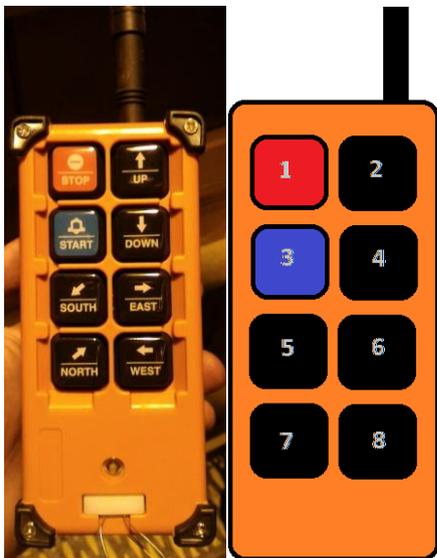
Комплект состоит из радиопульта, который при работе находится у оператора механизма, и приемника сигналов, который подключен к подъемному устройству и в котором срабатывают соответствующие реле.
