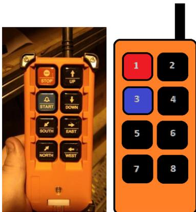
Комплект состоит из радиопульта, который при работе находится у оператора механизма, и приемника сигналов, который подключен к подъемному устройству и в котором срабатывают соответствующие реле.
