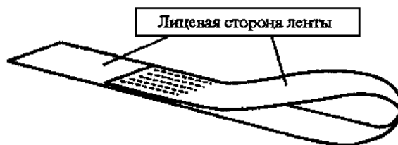
Рис. 6. Скрученная петля стропа
